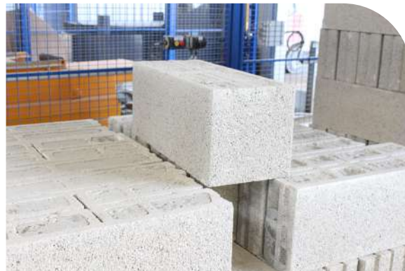
Fabrication de blocs Airium
