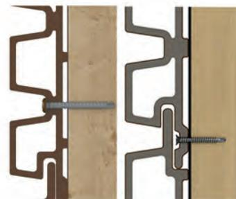
En pose verticale, les lames de bardage se vissent avec des vis auto-perceuses Inox A2 à tête fraisée 4.2x32 mm dans la languette basse de la lame. **L'assemblage entre les lames masque ainsi totalement la fixation.**
