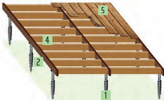
(1) vis fondation avec woodpro ou woodbasic (2) poutres (3) lambourdes (4) poutres chaînage (5) lames de terrasse
