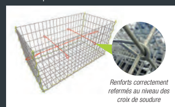
ÉTAPE 6 ▶ Mise en place des renforts
