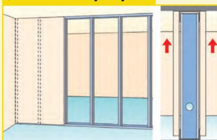
Positionner les plaques de plâtre dans le sens de la hauteur, jointives sur les montants et les buter en plafond.
