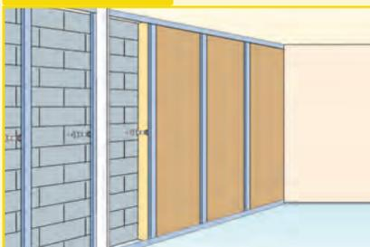
Régler finement la position de la tête des appuis en vérifiant la verticalité des fourrures. Positionner l'isolant entre le mur et les fourrures, le pare-vapeur côté intérieur de la pièce.
