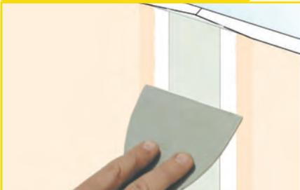
Imprégner la bande avec l'enduit. Serrer à la spatule de haut en bas pour éliminer l'excédent d'enduit, sans trop appuyer, spatule en position inclinée. Laisser sécher le temps indiqué au dos du sac.
