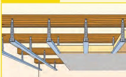
Si un isolant est prévu, le disposer sur les ossatures avant la fixation des plaques de plâtre. Le pare-vapeur de l'isolant doit être positionné côté source de chaleur.
