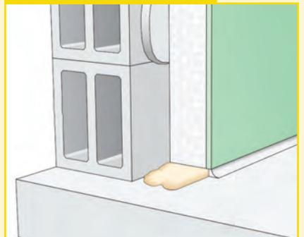
Dans les pièces humides, après séchage d'environ 24 h, mettre un joint souple si le sol est brut (mastic acrylique).
