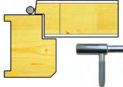
Bloc-porte technique : la porte à chant droit ou rive droite (RD) pivote sur des paumelles et pénètre totalement dans la feuillure de l' huisserie.
