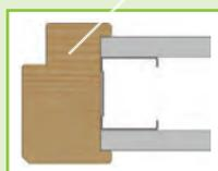
Avec des huisseries de 88 ou 90 mm de largeur, les deux plaques de plâtre s'inséreront dans la feuillure de l'huissérie, entre sa lèvre et le rail.
