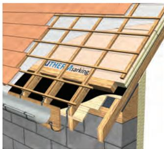
Le **SARKING** est un procédé d'isolation thermique par l'extérieur (ITE) de toitures inclinées. Ce concept est caractérisé par la pose de panneaux isolants rigides au-dessus des chevrons ou fermettes.
