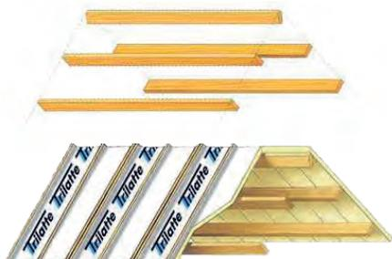
Le système «caisson chevronné» est constitué de chevrons en bois massif solidaires d'un panneau de sous-face faisant office de parement plafond. L'isolant est disposé entre les chevrons en ménageant un espace pour la ventilation de la couverture.
