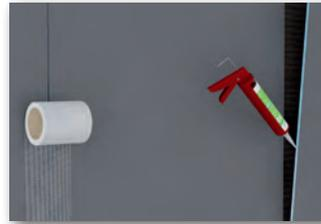
Dans les pièces humides, les jonctions peuvent être étanchées avec la colle polymère 610. Traiter ensuite les jonctions entre les panneaux de construction avec la bande d'armature autocollante.
