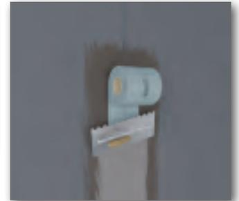
Les jonctions et percements peuvent alternativement être étanchés à l'aide de la bande d'étanchéité et de la colle à carrelage. Carreler ou enduire ensuite.
