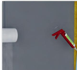
Dans les salles d'eau, les jonctions peuvent être étanchées en utilisant la colle polymère 610. Ensuite, armer les jonctions avec la bande d'armature autocollante.
