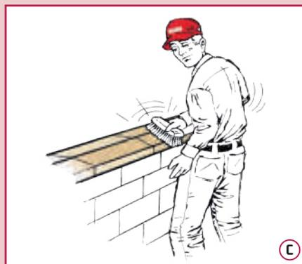
Après 4 h minimum, réaliser les joints au mortier en protégeant les parties latérales du joint avec un ruban adhésif pour ne pas tacher les pièces.
