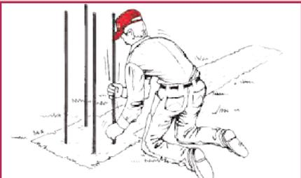
Ancrer 4 tiges de fer de 10-12 mm lors du remplissage des fondations pour les piliers. Attendre minimum 36 heures avant de commencer l'installation.
