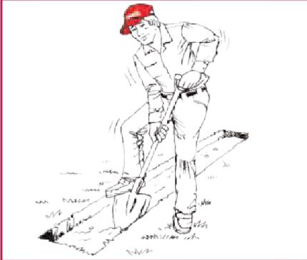
Faire une fondation de 40 à 50 cm de profondeur pour les piliers et 25 cm pour les murets avec une largeur de 10 cm de plus que la dimension du pilier et muret.
