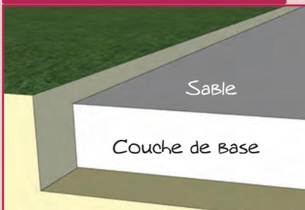
La pente de la couche de base (nappe géotextile sous calcaire concassé 0/30 dans le cas d'une pose sur lit de sable ou couche béton armé dans le cas d'une pose sur mortier) doit être identique à celle du sol fini, au minimum 1 cm par mètre pour faciliter l'évacuation des eaux de ruissellement.
