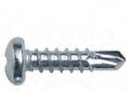
Vis auto-perceuse à tête ronde et à pointe foret, pour l'assemblage et la fixation métal sur métal (montant sur rail, fourrure sur lisse ou rail...). Ø 3,5 mm.
