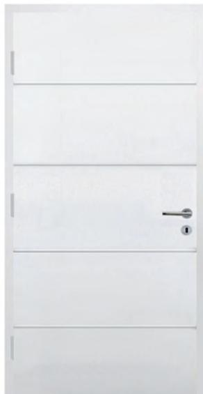
Lisse et contemporain. Décors matricés horizontaux. Huisserie CREA-CONFORT de 88 mm pour cloison de 72 mm (ou 50 mm pour les blocs-portes isolants). Huisserie à recouvrement : 3 fiches zinguées. Porte épaisseur 40 mm, poignée vendue séparément. Panneau MDF prépeint, matricé deux faces (fond de rainure prépeint).
