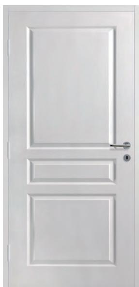
Postformé, veiné, intemporel. Huisserie CREA-CONFORT pour cloison de 72 mm (ou 50 mm pour les blocs-portes isolants). Huisserie à recouvrement : 3 fiches zinguées. Porte épaisseur 40 mm, poignée vendue séparément. Panneau MDF prépeint, postformé veiné deux faces.
