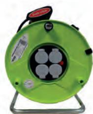
1 fiche 2P+T 16A/230V. 4 prises 2P+T 16A/230V avec clapets. IP 44. Disjoncteur thermique. Puissance maxi : câble déroulé 3500 W, câble non déroulé 1000 W. Protection enfants. Tambour monobloc moulé en matière très résistante. Support en acier galvanisé. Poignée guide-câble. Bouton tournant logostar. Produits conformes à la norme NF C 61-314.
