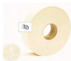
Rouleau de bande en papier kraft « spécial joint » à fibres longues, microfibré, débullé, défibré, délaminé, blanchi et traité anti-humidité. Associée à un enduit pour joints, la bande est destinée au traitement des joints de plaques de plâtre à bords amincis, en partie courante ainsi qu'au traitement des angles rentrants. Pré-pliage central pour assurer le bon fonctionnement de la bande lors de son application.
