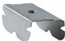
Accessoire de suspension de plafonds en plaques de plâtre qui assure la liaison entre fourrures et tiges filetées de diamètre 6 mm. Utilisation sur tous types de fourrures. F45 et F47.
