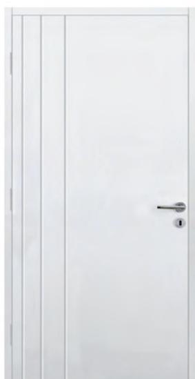
Lisse et contemporain. Décors matricés verticaux. Huisserie CREA-CONFORT de 88 mm pour cloison de 72 mm (ou 50 mm pour les blocs-portes isolants). Huisserie à recouvrement : 3 fiches zinguées. Porte épaisseur 40 mm, poignée vendue séparément. Panneau MDF prépeint, matricé deux faces (fond de rainure prépeint).
