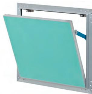
Création d'ouvertures pour accéder à des installations techniques, aux combles d'habitations, pour permettre de réaliser des inspections et des réparations. Pour un montage mural, positionner la fermeture vers le haut. Convient dans les pièces humides.
